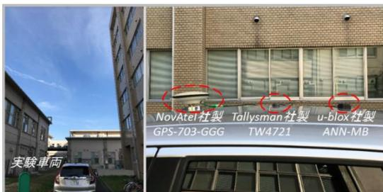
図 3.10 実験風景と移動局の GNSS アンテナ
